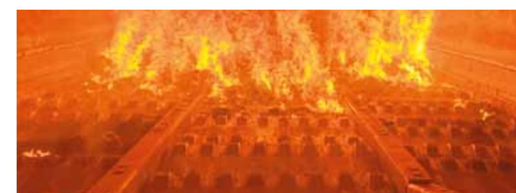
Bei der thermischen Abfallverwertung – umgangssprachlich „Müllverbrennung“ – wird der Restmüll bei Temperaturen bis zu 1.000 Grad verbrannt.
