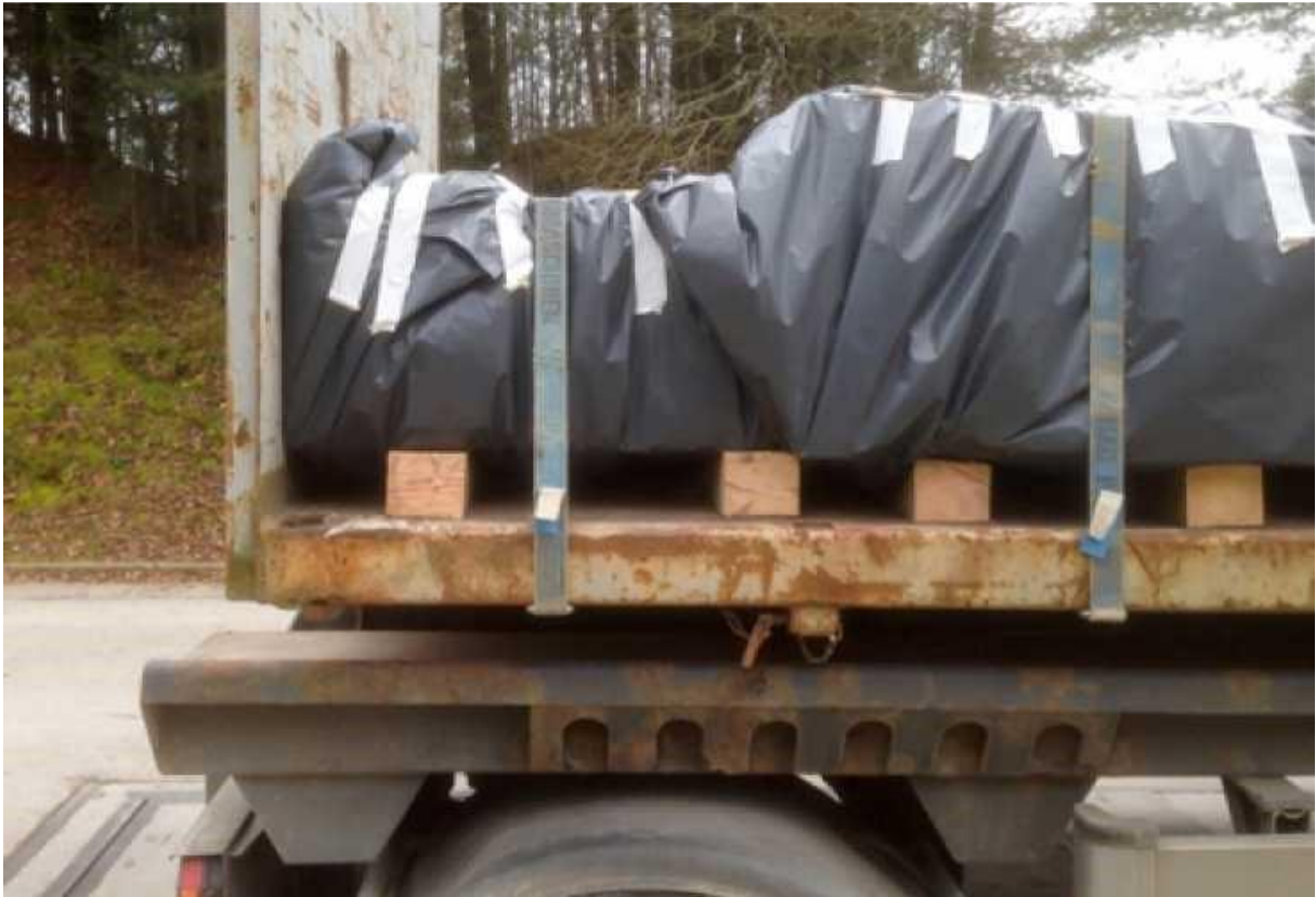
Großes verpacktes asbesthaltiges Bauteil auf Kanthölzern mit Ladungssicherung
