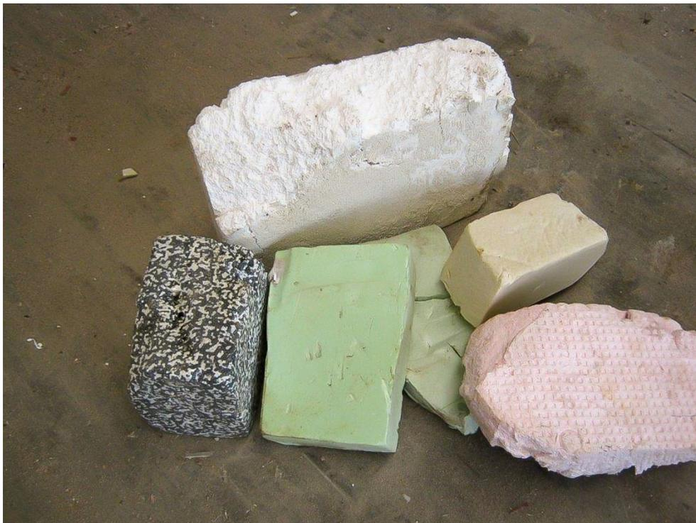
Typische Bestandteile von Wärmedämmverbundsystemen und POP-haltigen Dämmstoffen
