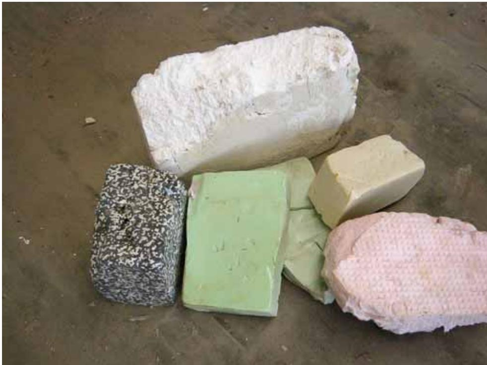
Typische Bestandteile von Wärmedämmverbundsystemen und HBCDD-haltigen Dämmstoffe
